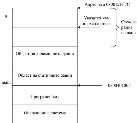
Фигура 1.8. Организация на оперативната памет при решаване на задачата за намиране лицето и обиколката на правоъгълника при деклариране типа на променливата a
